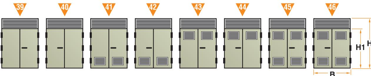
**Zweiflügelige Türen mit zusätzlicher Blende oben** Breite min. 1460 mm Höhe min. 2400 mm Höhe H1 min. 1850 mm (Mauermaß)
