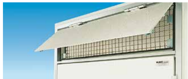
Druckentlastungsklappe mit Magnetverschluss, öffnet bei Überdruck und schließt nach Druckausgleich selbsttätig.
