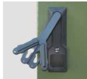
Herausschwenkbarer Aluminium-Knebel mit integriertem Durchsägtenschutz, für zwei 40 mm Profilhalbzylinder (30/10).
