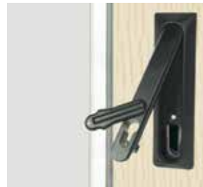
Herausschwenkbarer Aluminium-Knebel mit integriertem Durchsägtenschutz, für 40 mm Profilhalbzylinder (30/10).
