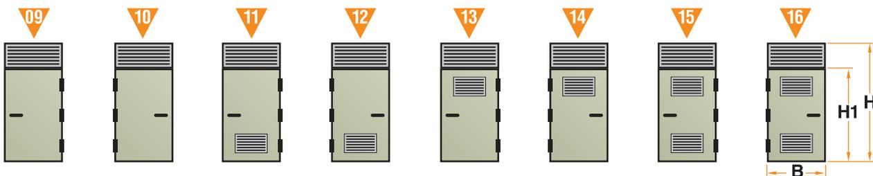
**Einflügelige Türen mit zusätzlicher Blende oben** Breite min. 550 mm Höhe min. 2400 mm Höhe H1 min. 1850 mm (Mauermaß)
