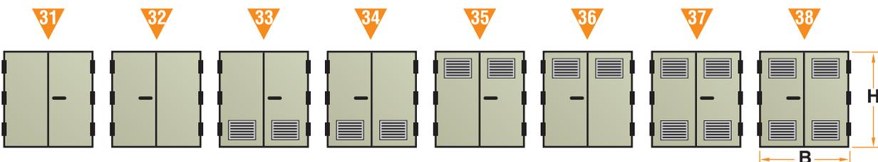
**Zweiflügelige Türen mit zusätzlicher Lüftung oben** Breite min. 1460 mm Höhe min. 2400 mm Höhe H1 min. 1850 mm (Mauermaß)
