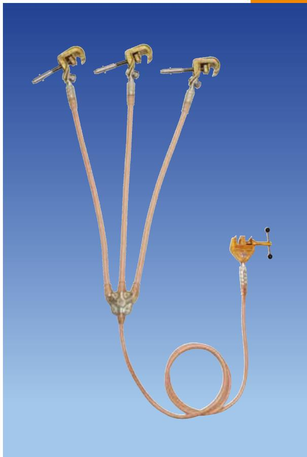
Universal-Erdungs- und Kurzschlievorrichtungen sind mit Universal-Phasen-Schraubklemmen **MT-1911** mit Anschlussmglichkeit auf Phasenfestpunkt kugelfrmig **20 mm Ø**, auf Phasenfestpunkt **t-frmig**, auf Flachleiter bis **18 mm Ø** oder mit Universal-Phasen-Schraubklemmen **MT-1921** mit Anschlussmglichkeit auf Phasenfestpunkt kugelfrmig **25 mm Ø**, auf Phasenfestpunkt **t-frmig**, auf Flachleiter bis **28 mm** Strke, auf Rundleiter bis **25 mm Ø** lieferbar.
