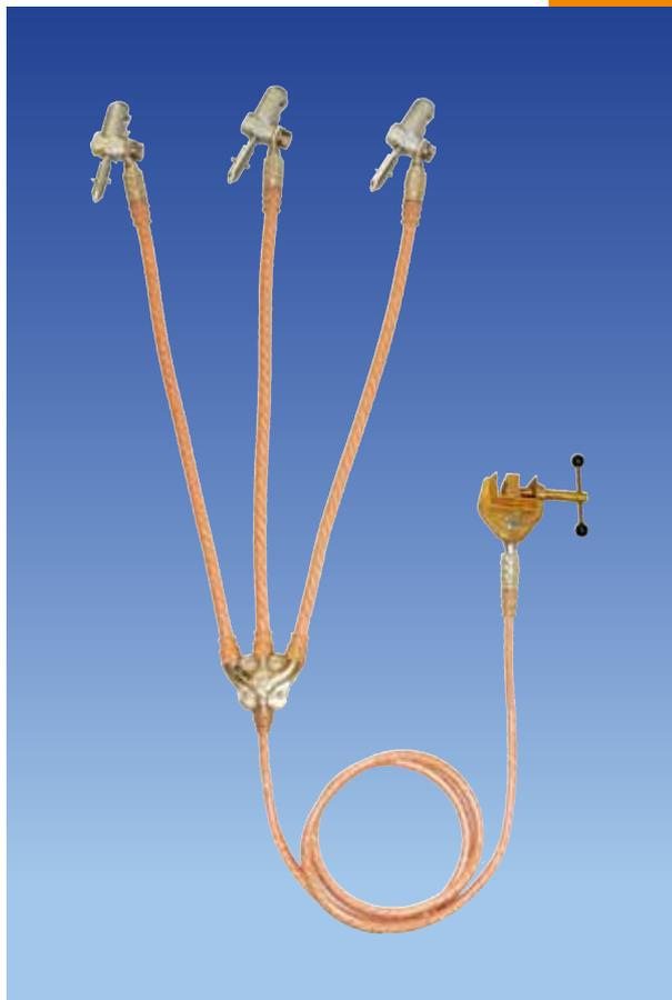
Kugelpf-Erdungs- und KurzschlieÙvorrichtungen sind mit Kugelpfklappen für Kugeldurchmesser **20 mm** oder **25 mm** lieferbar. Die Betätigung der Kugelpfklappen erfolgt mittels Bajonettspindel. Der Erdungspunkt kann mit einer **Universal-Erdungsklemme Ausf. A** oder einer unverlierbaren **Flügelmutter M 12 Ausf. B** ausgerüstet werden.
