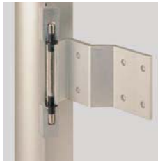
Stabile Aluminium-Scharniere mit Nirostbolzen und Kunststoffbuchsen aus Delrin, einbruchgeschützt.
